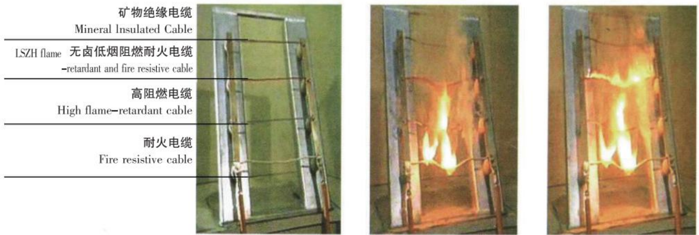
电缆过载试验 Cable overload test
